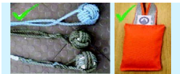
图3 绳索和布片制成的撇缆头结
