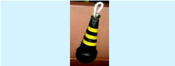
图5 日本港口使用的 \phi 6\sim 8 mm纯橡胶质蒜锤形撇缆头
